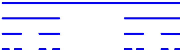
L'insieme di Cantor è l'insieme che si ottiene con infinite iterazioni, rimuovendo ad ogni passaggio solo il segmento centrale che si forma nella suddivisione di ciascun segmento in 3 segmenti più piccoli; dunque, in definitiva, l'insieme di Cantor è costituito dalla parte blu che rimane in figura, dopo infinite iterazioni.
