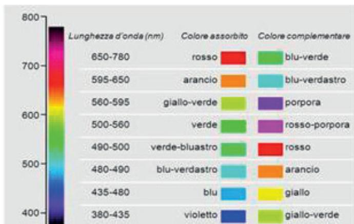
La molecola con sistemi coniugati è in grado di assorbire alcune radiazioni (e questo è misurabile con un apparecchio, spettrofotometro UV-visibile) riflettendone altre. In particolare, la dipendenza del colore dalla radiazione assorbita è riportata in Tabella. La comparsa del colore dipende dal numero di doppi legami coniugati (deve essere almeno  $> 7$ ).
