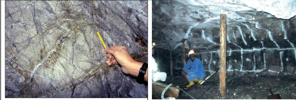
Figura 5. (a sinistra) Tipico aspetto di un giacimento di rame delle Ande: vene di solfuri di rame in roccia porfirica (Miniera di El Teniente, Cile). (a destra) Pannello di estrazione in una miniera di platino in Sud Africa (Bushveld).
